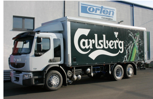
Renault Premium 430.26 D mit SafeServer Aufbau
